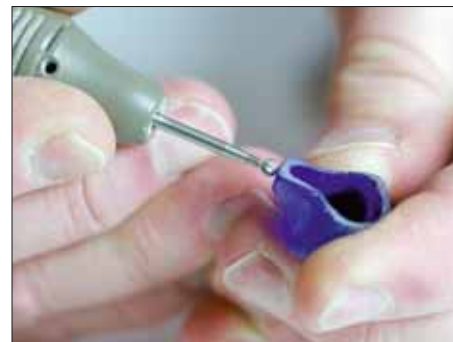
• Mit einer kleinen Fräse wird das Gehäuse nachgearbeitet
